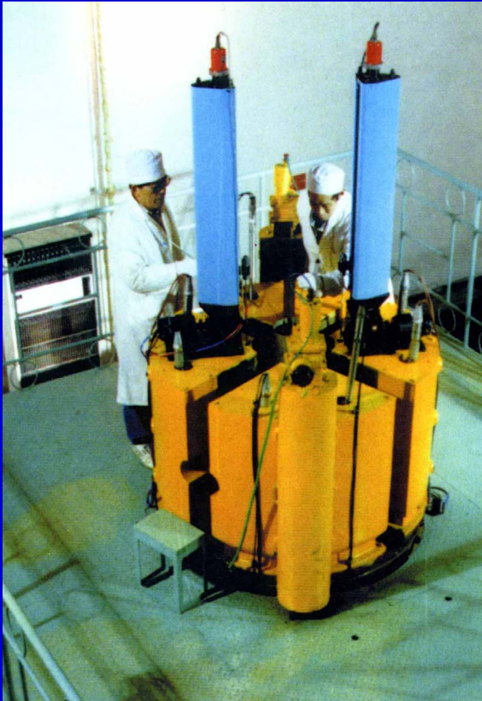
东风六号（DF-6）快中子临界装置
